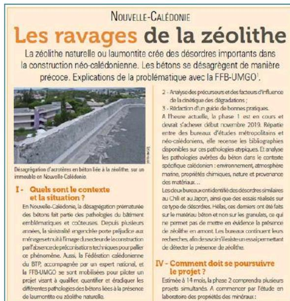
L'objet des travaux du RCNC est de créer un amendement au DTU 21 d'exécution des ouvrages en béton, pour prendre en compte des mesures destinées à réduire la sinistralité due à la présence de laumontite dans les agrégats calédoniens composant les bétons bétons.
